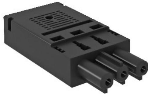
Partie prise, 3 broches, type GST18i avec le printemps de la puissance de raccordement pour câbles rigides de 1,5-2,5 mm<sup>2</sup>, à fil unique et soudé par ultrasons, beaux-fils des câbles de 1,5 mm<sup>2</sup> avec embout, démonté avec décharge de traction, peut être résilié in situ, 250 V, 16 A.
