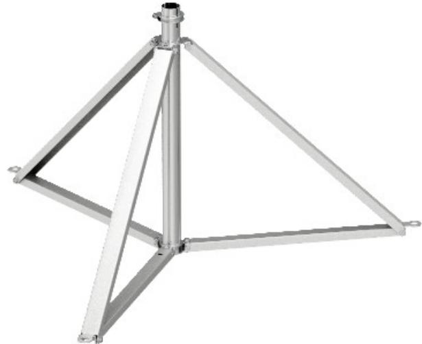
Pliage trépied sans vis pour l'installation de la libre-debout interception des tiges d'un diamètre de 40 mm, par ex. pour OBO isCon® câble. Pente du toit max. 5 degrés. Incl. Rd 8-10 barre transversale pour rapide tour chef d'orchestre de fixation. Le socle en béton et des tiges filetées doivent être commandées séparément.
