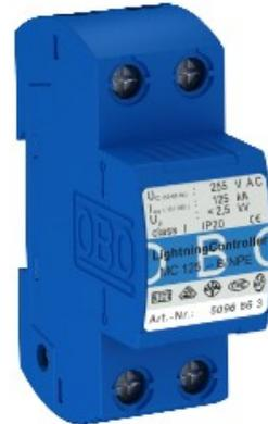
MC 125-B/NPE: Pour une utilisation en TN-S et TT les systèmes N-PE de décharge de l'écart type 1 (Classe B) IEC 61643, pour l'interface 0 à 1 (ZPP) selon la foudre concept de zone de protection IEC 61312-1 et/ou DIN V VDE V 0185 de la Partie 4 pour l'utilisation de libération de l'écart entre N et PE.
