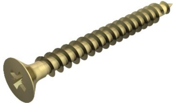
En acier trempé, électro galvanisé et jaune passivé, ainsi que Hostaflon-couché, tête fraisée à tête Philips (Pozidrive taille 2 à l'exception de Ø 6 mm Pozidrive taille 3). L'utilisation de Sprint vis conduit à considérablement réduit vis-à temps par rapport à la norme vis. Cette remarquable prestation est réalisée par le point avec le premier thread, qui mène à la double filet au-delà.
