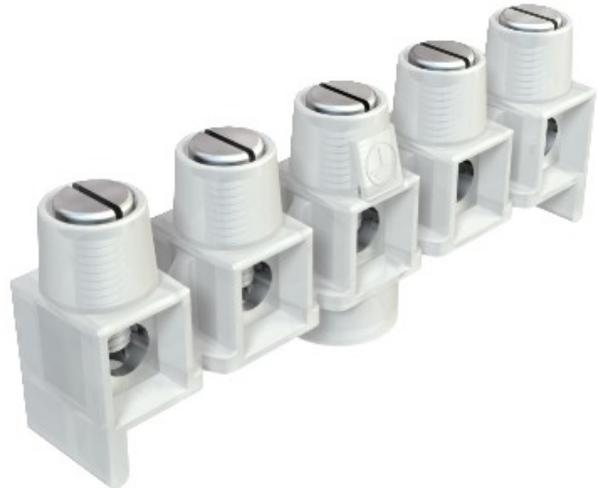
Bornier, nickelé laiton, vis en acier, en acier galvanisé et de manière transparente passivé, nominale de la section transversale 0,8 - 2,5 mm<sup>2</sup>, tension nominale 660 V, 5-pôles, avec terminal sockets, max. connectable sections par terminal: 4 x 2,5 mm<sup>2</sup> 5 x 1,5 mm<sup>2</sup> ou 6 x 1 mm<sup>2</sup>, inutile de poteaux peuvent être coupés et utilisés comme terminaux individuels.
