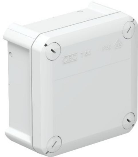
Les boîtes de jonction sont faits d'un thermoplastique polypropylène polymère clos de murs latéraux. Cela signifie que les ouvertures peuvent être faites partout où ils sont nécessaires. EDK plug-in les phoques ou les presse-étoupes avec écrous de blocage peut être inséré dans ces ouvertures, pour permettre l'insertion du câble. Les boîtes de jonction peuvent être montés sur des plaques de montage dans les orifices sur le sol à l'aide de vis en acier de 3,5 x 9,5.
