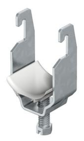
Convient pour tous les C profil des rails avec fente de largeur 18 mm et 22 mm. Également adapté pour la télévision, de l'angle et de U en acier de 4 - 12 mm d'épaisseur. BBS de serrage de boulon et fait des galvanisé à chaud de l'acier. Polypropylène pression manches, sans halogène, couleur gris clair RAL 7035.
