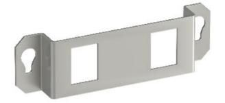
Support de montage pour accepter des données de deux modules de connexion de l'un des types suivants: AMP TYCO: Standard 110Connect, SL Série 110Connect et sans outillage, AMP-Twist; Brand-Rex: non blindé; GG45; TKM RJ MOD; Nexans: LANmark avec Adaptateur-Clip; Siemon CAT6; 3M K6 et K10. Dimensions du trou de montage en mm: 20.10 x 14.80.
