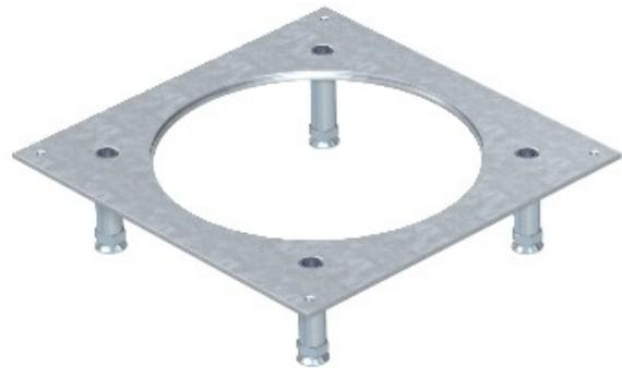
Lourds de montage couvercle pour UZD250-3 pour l'installation d'une tour de lourds cassette de taille nominale R4. Avec quatre lourds, des soutiens qui sont connectés à la fixation du couvercle et sont réglables en hauteur. Réglage de la hauteur de boulons avec écrous de blocage pour fixer la hauteur. L'installation de l'ouverture de 3 mm à encastrer pour plus tard découpage de blocage avec couvercle aveugle de la plaque.
