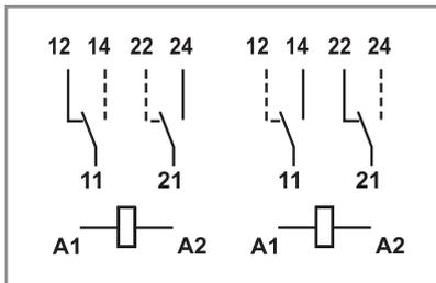
Choix de sélection des contacts NO et NC pour utilisation en contacts guidés (liés mécaniquement), selon la norme EN 50205 (type B).
