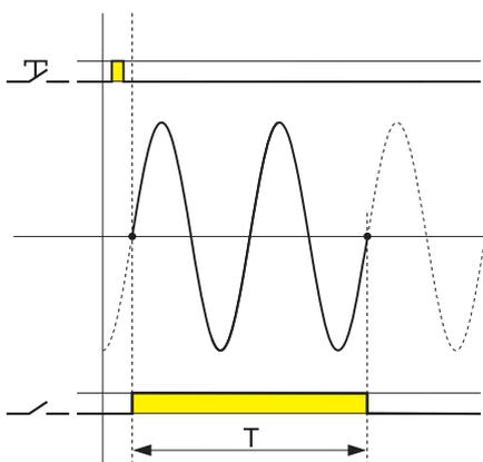
1. Des pics de courant plus faibles protègent la lampe et permettent un nombre de commutations plus important de celle-ci.
