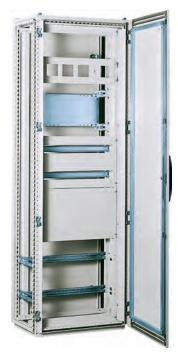
**Description:** Cadre de support pour faciliter l' installation de panneaux modulaires de fermeture et perforés au pas de 150mm. L' espace disponible en hauteur pour l' appareillage est de 46mm. En utilisant les rails DIN PP 0735, on peut atteindre 54mm. La platine de montage reste utilisable et l' on obtient 80 mm d' espace entre la porte standard ou vitrée et le panneau fixé, pour les appareils en saillie.
