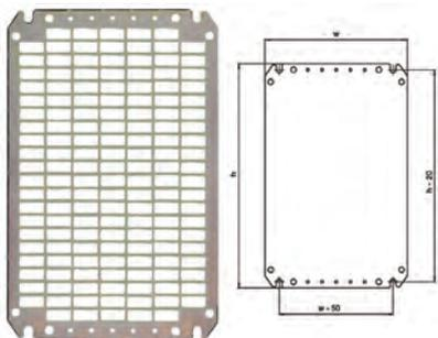
**Description:** Facilite l'installation et la fixation du matériel. Perforations rectangulaires de 26 x 11mm permettant d'obtenir les positions de fixation désirées à l'aide des écrous à clipser (TN). Les écrous peuvent être incérés à l'intérieur de la perforation rectangulaire. Positionnement en profondeur possible avec le kit AMG
