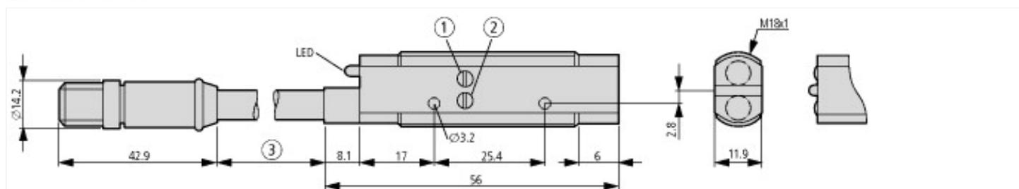
Capteur avec adaptateur mis en place
