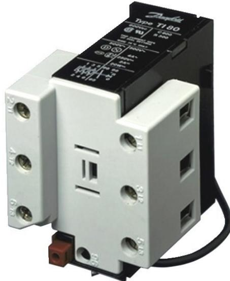
Les relais thermiques TI 80-86 couvrent la plage comprise entre 16 et 85 Amp et protègent les moteurs à rotor en court-circuit contre la surcharge jusqu'à 45 kW. Pour un usage avec les contacteurs CI 32 à CI 86 Conception compacte Bouton d'arrêt/de remise à zéro Fonction de remise à zéro manuelle/automatique Fonction de déclenchement de test Échelle DOL / Contact de permutation Protection contre les ruptures de phase simples
