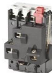
Les relais thermiques TI 16C-30C couvrent la plage comprise entre 0,13 et 32 Amp et protègent les moteurs à rotor en court-circuit contre la surcharge jusqu'à 15 kW. La fonction de rupture de phase accélère la fonction de déclenchement de trois exécutions de phases en cas de désexcitation de phase. Ceci est primordial pour les moteurs connectés en triangle. Pour un usage avec les contacteurs CI 6 à CI 30
