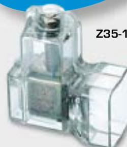
Bornes unipolaires pour la connexion et la dérivation des conducteurs de 0,5 à 35 mm<sup>2</sup>. Compactes et robustes, elles facilitent la réalisation rapide et fiable des installations électriques dans les câblages tertiaires et industriels. Les bornes sont à serrage indirect, ce qui garantit une excellente tenue de la connexion dans le temps. Le fût conique permet l'insertion rapide et aisée du conducteur.
