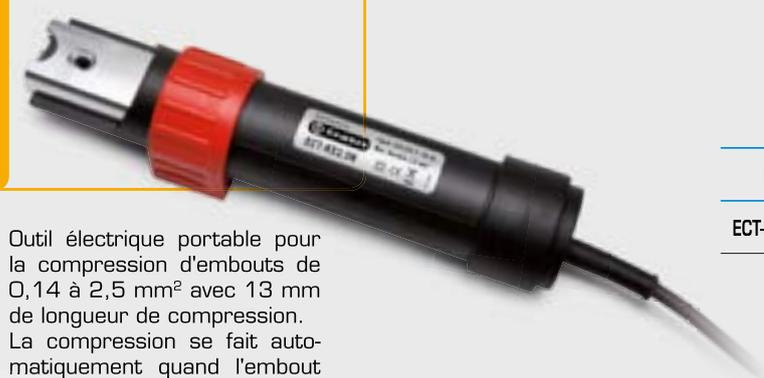
Outil électrique portable pour la compression d'embouts de 0,14 à 2,5 mm<sup>2</sup> avec 13 mm de longueur de compression. La compression se fait automatiquement quand l'embout active l'interrupteur intérieur de pression.
