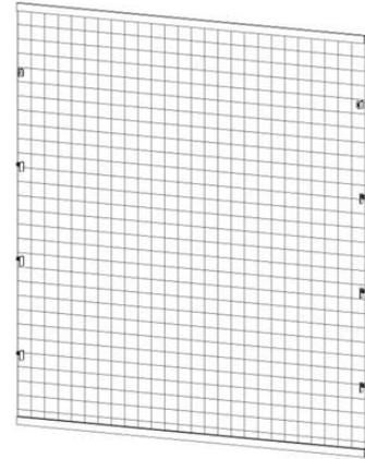
Rapide-Garde de la section E sans profils. Y compris les composants soudés maille 1474x1216mm, netlocks et de protection de bord. Hauteur totale 1400 mm, largeur 1500mm c-c profils.
