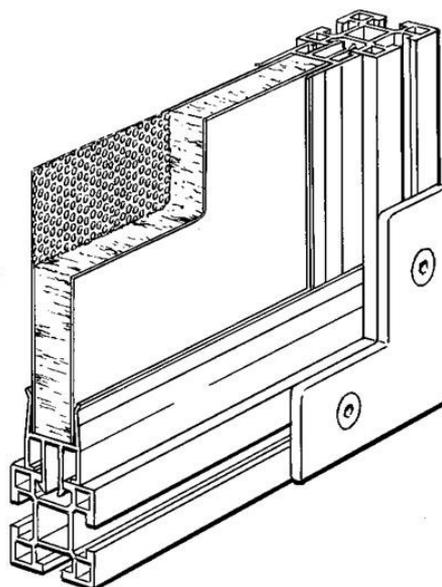
Montage profil de 25mm absorbant acoustique des panneaux. Naturel anodisé
