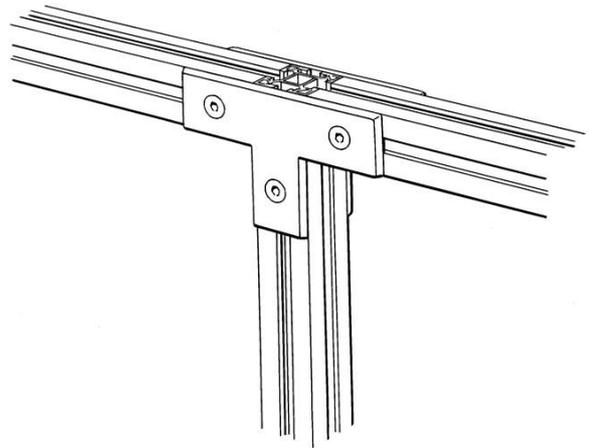
En forme de T support de montage en Aluminium pour le montage des profils, pré-assemblés.
