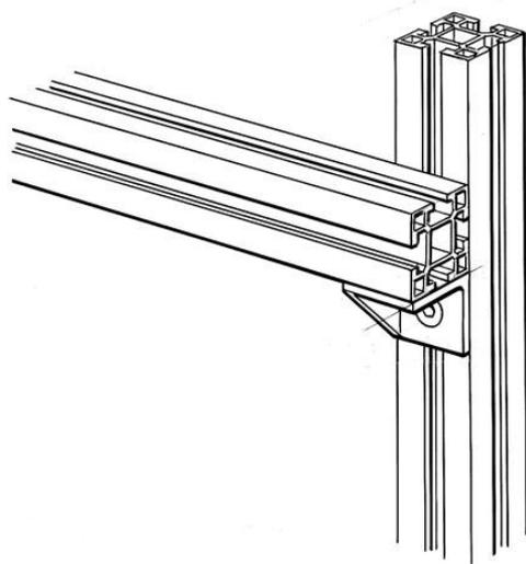
Petit angle du support en aluminium. Dimension 40x40x40mm. avec un compteur coulé trou, pré-assemblés.
