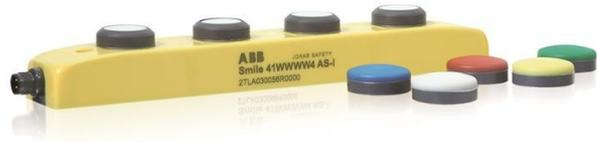
Bouton-poussoir à cocher selon le motif de Sourire avec 4 boutons. La boîte est adapté pour le système as-i. Les boutons programmable LED d'état en bouton. Connexion via un connecteur M12 à 5 broches, connecteur mâle.
