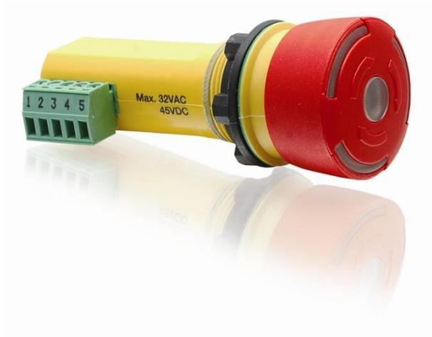
Bouton d'arrêt d'urgence pour montage sur panneau, 22,5 mm trous, 2 x NC, le Statut de la LED dans le bouton, les blocs de jonction.
