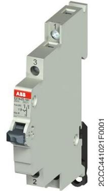
Groupe de commutateurs (I-0-II) selon la norme DIN EN 60669-1, VDE 0632 la Partie 1, les courants nominaux: 16/25 A, 250 VACPDC, des Contacts: 1 CO/2 CO, Module largeur: 0,5/1
