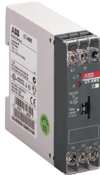
Le CT-AWE est une fonction unique électronique relais temporisé de la CT-E minuteur de gamme. Il fournit une impulsion (bord de fuite de l'intervalle) fonction avec un intervalle de temps de 0.05 s à 1 s. Cette fois, le relais fonctionne avec une puissance de contrôle de la tension d'alimentation de 24 V CA / CC et il a un 1 c/s (INVERSEUR) sortie nominale 250 V / 4 A. Une entrée de commande fonctionne avec une tension de (non flottant) de déclenchement.
