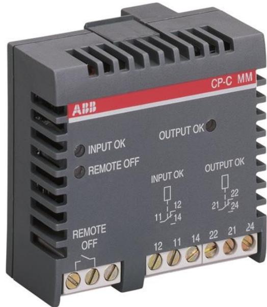
Le CP-C MM est un module de messagerie enfichable sur CP-C de la gamme de blocs d'alimentation. Ce module assure la surveillance de la tension d'entrée de l'unité d'alimentation et de messagerie si au-dessous de la valeur limite. En cas de découplée de fonctionnement parallèle, il fournit également de la tension de sortie de surveillance. Par le biais d'une TÉLÉCOMMANDE-OFF l'entrée du bloc d'alimentation peut être désactivé à distance.
