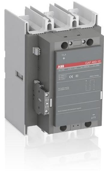
Un 3 pôles du Contacteur adapté pour DC-1 pour les applications où les trois pôles doit être connecté en série à 1 pôle de configuration jusqu'à 1000 VDC. Exploité avec le contrôle de l'ensemble de la plage de tension de 100 à 250 V AC/DC
