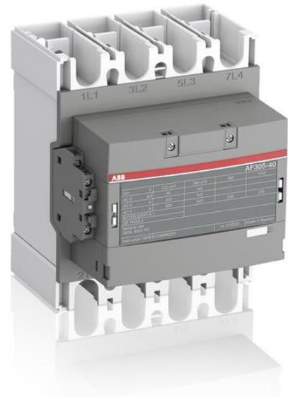
3-phase Contacteur adapté à diverses applications telles que le démarrage du Moteur, de l'isolement, de By-pass et de la Distribution de l'application jusqu'à 1000 V. Exploité avec le contrôle de l'ensemble de la plage de tension 250 à 500 V, 50/60 Hz, DC
