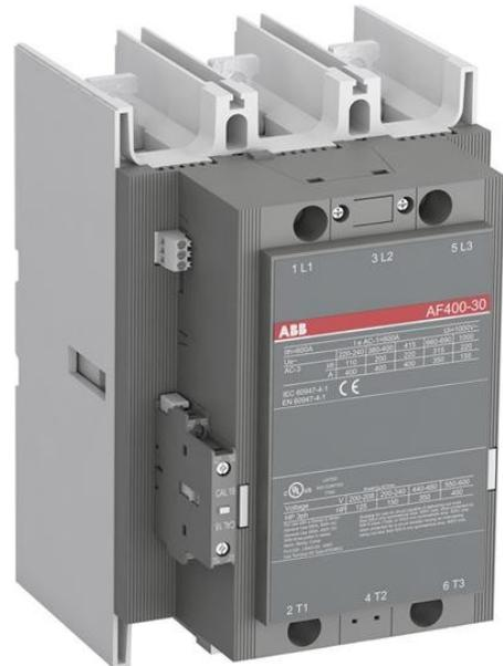
3-phase Contacteur adapté à diverses applications telles que le démarrage du Moteur, de l'isolement, de By-pass et de la Distribution de l'application jusqu'à 1000 V. Exploité avec le contrôle de l'ensemble de la plage de tension de 100 à 250 V AC/ DC
