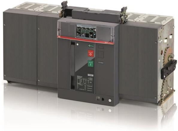
PARTIE mobile POUR C. DISJONCTEUR SACE EMAX2 E6.2H DE 5000 à TROIS PÔLES AVEC L'ÉTAT SOLIDE à LIBÉRATION EN AC EKIP/DIP-LSIG R 5000 ÉQUIPÉ: 4 CONTACT AUXILIAIRE ET C. DISJONCTEUR EN POSITION OUVERT-FERMÉ
