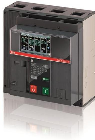
C. DISJONCTEUR SACE EMAX2 E1.2C 1600 FIXE à QUATRE PÔLES AVEC des TERMINAUX FRONT ET à l'ÉTAT SOLIDE à LIBÉRATION EN AC EKIP/DIP-LSIG R 1600 ÉQUIPÉ: 4 CONTACT AUXILIAIRE ET C. DISJONCTEUR EN POSITION OUVERT-FERMÉ
