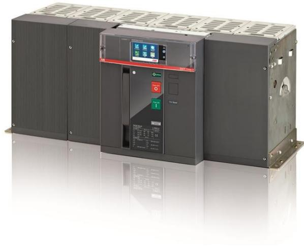
C. DISJONCTEUR SACE EMAX2 E6.2V 5000 FIXE à TROIS PÔLES AVEC BORNES à l'ARRIÈRE HORIZONTAL ET à l'ÉTAT SOLIDE à LIBÉRATION EN AC EKIPTOUCH-LSI R 5000 ÉQUIPÉ: 4 CONTACT AUXILIAIRE ET C. DISJONCTEUR EN POSITION OUVERT-FERMÉ
