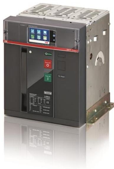
C. DISJONCTEUR SACE EMAX2 E2.2B 2000 FIXE à TROIS PÔLES AVEC BORNES à l'ARRIÈRE HORIZONTAL ET à l'ÉTAT SOLIDE à LIBÉRATION EN AC EKIP/G/TOUCH-LSIG R 2000 ÉQUIPÉ: 4 CONTACT AUXILIAIRE ET C. DISJONCTEUR EN POSITION OUVERT-FERMÉ
