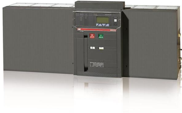
SACE EMAX DISJONCTEUR E6H 5000A QUATRE PÔLES FIXE AVEC BORNES à l'ARRIÈRE HORIZONTALE de SURINTENSITÉ de presse PR122/P-LSI R5000 ÉQUIPÉ: 4 CONTACT AUXILIAIRE ET C. DISJONCTEUR EN POSITION OUVERT-FERMÉ
