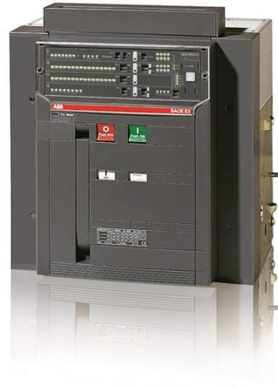
SACE EMAX DISJONCTEUR E3V 1600A TROIS PÔLES FIXE AVEC BORNES à l'ARRIÈRE HORIZONTALE de SURINTENSITÉ de presse PR121/P-LSIG R1600 ÉQUIPÉ: 4 CONTACT AUXILIAIRE ET C. DISJONCTEUR EN POSITION OUVERT-FERMÉ
