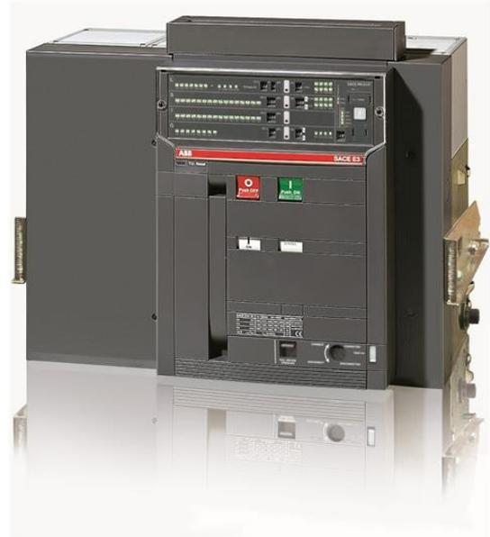
SACE EMAX PARTIE mobile POUR DISJONCTEUR E3H 800A QUATRE PÔLES de SURINTENSITÉ de presse PR121/P-LSIG R800 ÉQUIPÉ: 4 CONTACT AUXILIAIRE ET C. DISJONCTEUR EN POSITION OUVERT-FERMÉ
