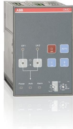
OME automatique des unités de contrôle peuvent être utilisés avec OTM40...2500\_CM\_ motorisé de changement de change dans l'ordre d'assembler un commutateur de transfert automatique. Le type et les codes de commande comprennent les OMD de l'unité de contrôle, connecteurs de carte PCB et de 2 attaches pour porte de montage.
