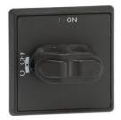
Sélecteur de type de poignée, Indication I-O et on-OFF. Pas distinct de l'arbre de besoin. Snap-on montage, porte de forage de 22,5 mm. Pas de cadenassage, IP 54, NEMA 1, noir, OT16...40FT
