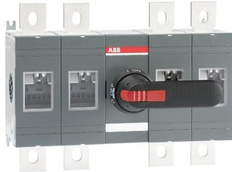
Y compris un noir en plastique de la poignée et de l'arbre en tant que norme. La poignée de protection IP65, padlockable en position ARRÊT et de verrouillage de la porte en position. La tige est réglable pour une gamme de l'installation des profondeurs.
